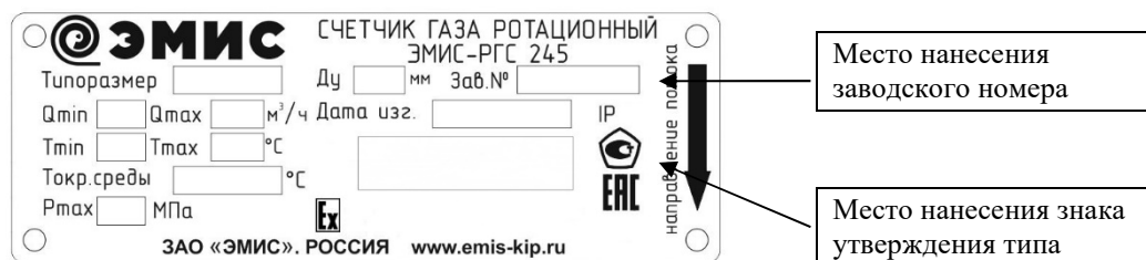
Рисунок 2 – Места расположения знака утверждения типа и заводского номера счетчика на маркировочной табличке
